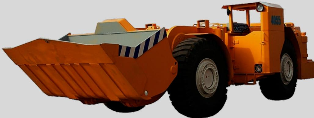
Предназначена для погрузочно-доставочных работ с взорванными или разрыхленными механическим способом породами в стесненных условиях подземных шахт и проходах, не опасных по пыли и газу, а также – в условиях открытой добычи полезных ископаемых, строительстве тоннелей и др.
