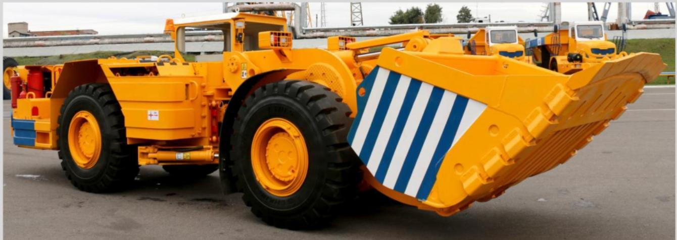
Предназначена для погрузочно-доставочных работ с взорванными или разрыхленными механическим способом породами в стесненных условиях подземных шахт и проходах, не опасных по пыли и газу, а также – в условиях открытой добычи полезных ископаемых, строительстве тоннелей и др.
