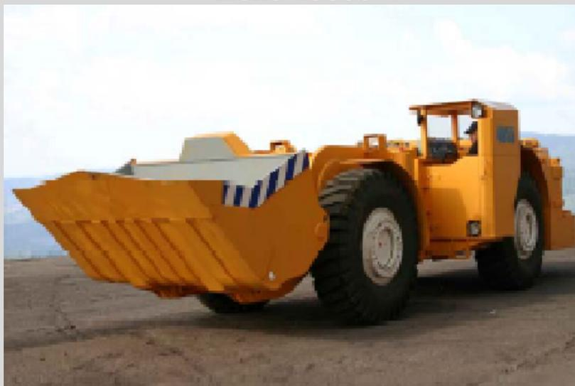
Предназначена для погрузочно-доставочных работ с взорванными или разрыхленными механическим способом породами в стесненных условиях подземных шахт и проходах, не опасных по пыли и газу, а также – в условиях открытой добычи полезных ископаемых, строительстве тоннелей и др.
